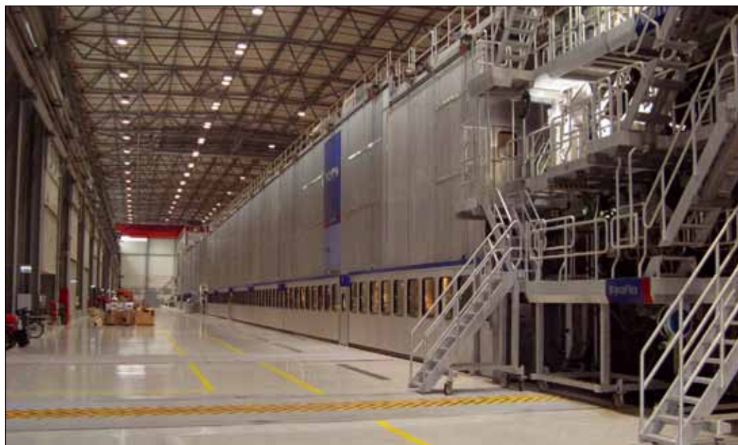
Maszyna papiernicza firmy Voith – szer. wstęgi 8,6 m, maks. prędkość 1800 m/min, gramatura 65-140 g/m 2 , roczna produkcja 455 000 ton. Fot. L. Goetzendorf Grabowski
