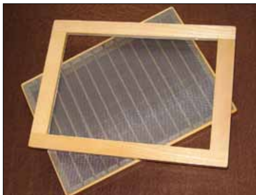
Forma czerpalna z siatką welinową wykonana przez autora.
