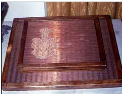
Formy czerpalne z siatką żeberkową i naszytym znakiem wodnym, wykonanym przez autora.
