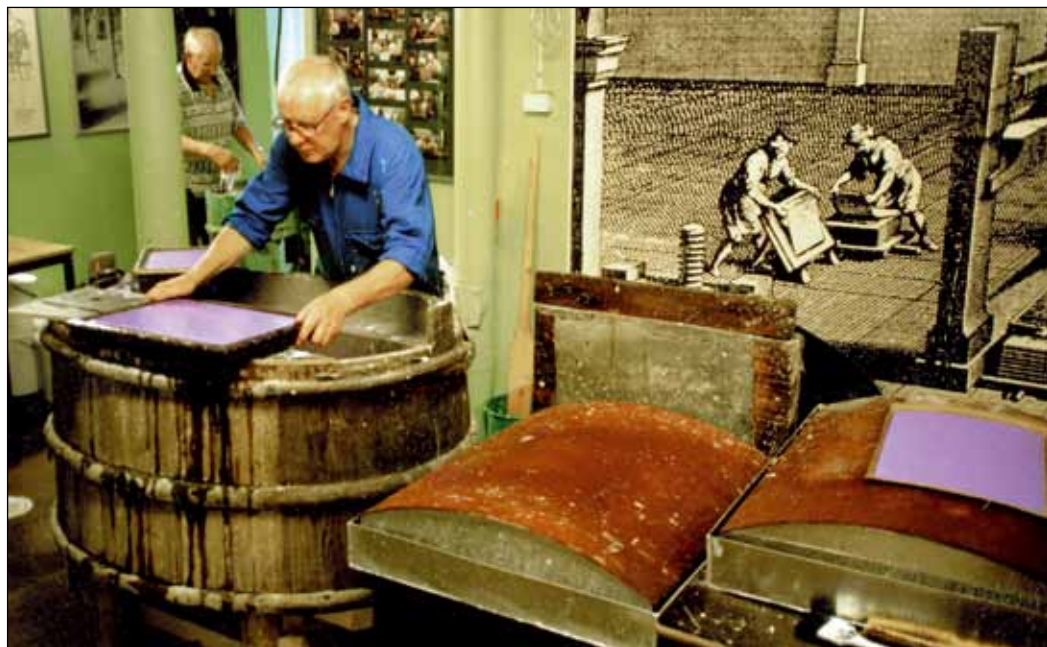
Typowe współczesne stanowisko do czerpania papieru w jednej ze szwedzkich czerpalni. Fot. ze zbiorów autora
