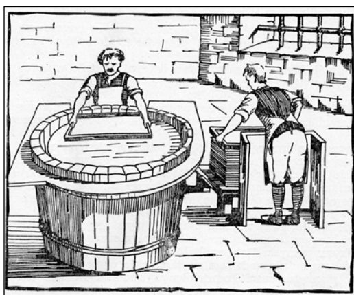
Proces czerpania arkusza papieru i formowania stosu arkusz/filc – przygotowanie go do prasy (źródło: Tournell 1949).
