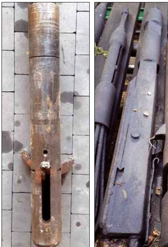
Noże do odcinania rur: z lewej do poziomego przecinania rur, z prawej do pionowego przecinania czopa rury. Fot. Janusz Pudło
